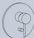
F3079X2 Miscelatore incasso doccia con deviatore a 2 uscite Built-in shower mixer with 2 outlets diverter
