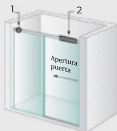
1. Tope final carrera 2. Freno posicionamiento
