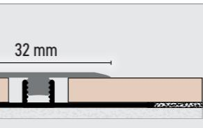
Kit dilatazione in alluminio per pavimenti con spessore da 5 a 7 mm, con base femmina in PVC.
