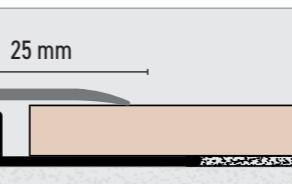
Kit terminale in alluminio per pavimenti con spessore da 5 a 7 mm, con base femmina in PVC.
